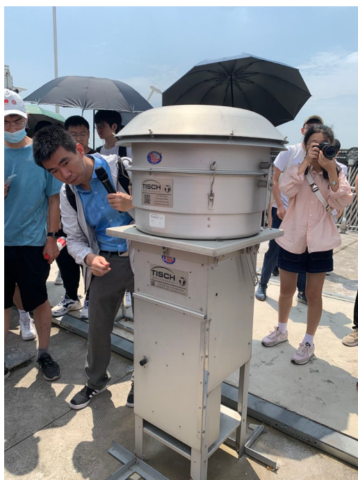
图 2 赵倩彪学长为我们讲解 TISCH 大流量采样器的工作原理
